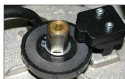
Механическая двухдисковая муфта (только для SATURN OIL)
