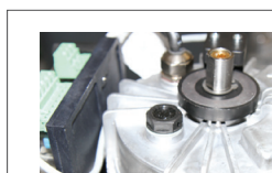
Электродвигатель и редукторы в масляной смазке
